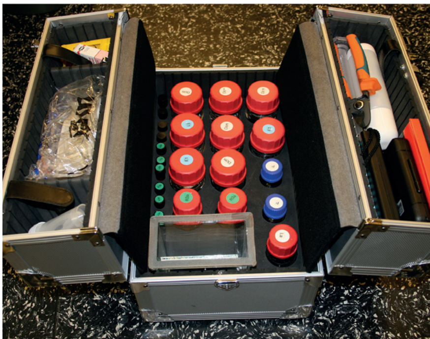
TLC-väska. Väskan innehåller alla delar som behövs för att genomföra en analys.
